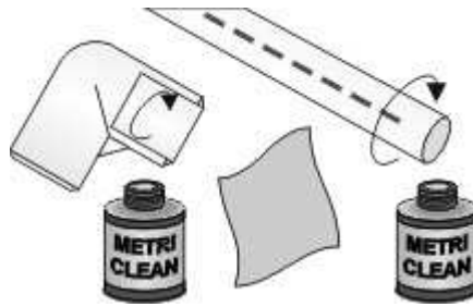
Rys. 7.3.1. Przygotowanie powierzchni do klejenia.
